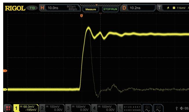
高刷新率模式下捕获偶发异常信号
